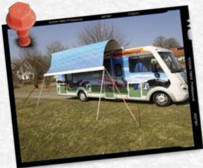
füße gegen Abheben zu sichern. Bei sehr böigem oder stärkerem Wind muss zusätzlich gesichert werden. Spezielle Sturmgurte sind hier die richtige Wahl. Ein Sturmgurt sollte immer auf einer Seite mit einer Feder, die auftretende Windkräfte ausgleicht, zum Boden gesichert sein. Wichtig ist bei einem Sturmgurt auch, dass
