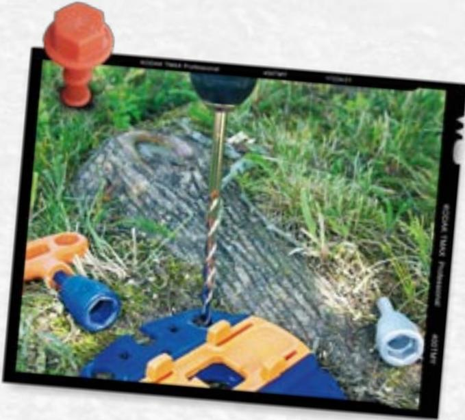
Kunststoff Peggs einfach per Akkuschauber ein Kernloch schaffen. In unserem Sortiment bieten wir das Pre-Drill-Set mit zwei zum System passenden Bohrern. Mit diesen wird ein 4-5 cm tiefes Loch vorgebohrt. Darin wird am besten per Hand der Schraubhering eingesetzt und mit Einsatz eines Hakens festgedreht.
